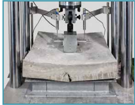
PLAK EĞİLME DENEYİ TS EN 14488-5
