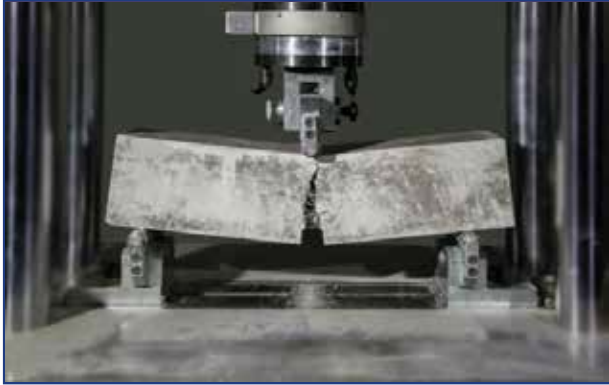
KİRİŞ EĞİLME DENEYİ TS EN 14651
